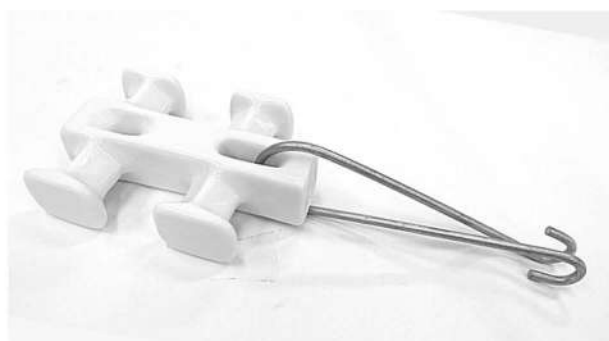
バインドレス碍子 関電型 2.6mm~22sq (穴は2カ所)
